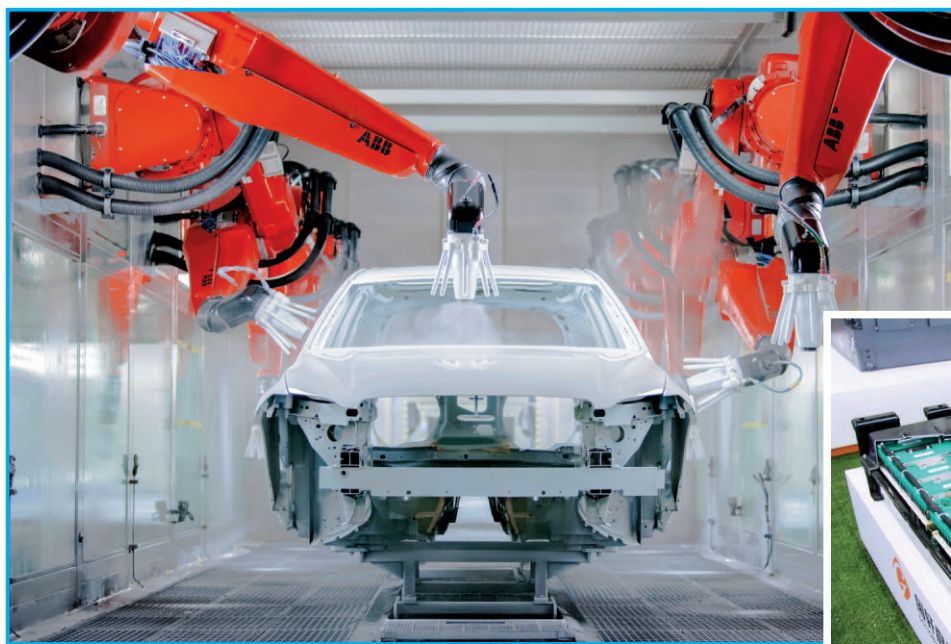
▲在补贴取消后，企业更应关注技术创新，图为沃尔沃成都工厂智能喷漆机器人。
